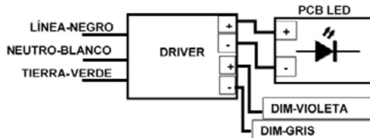
\*Si no utiliza cables de dimeo aislar ambos extremos.
